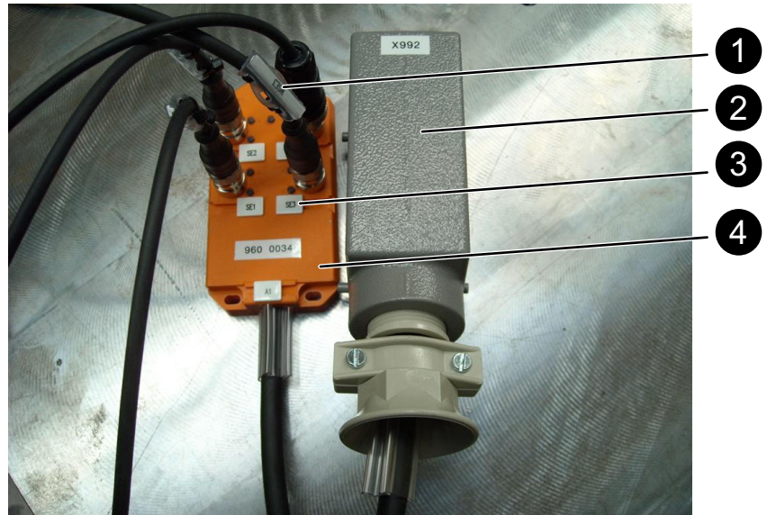
图4-10 插接分配器和电缆标签 ( 示例插图 )
