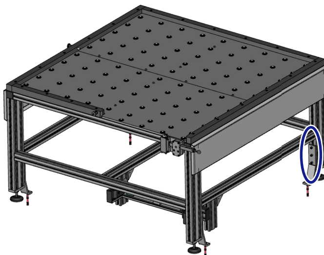
Fig. 4-86 Strângerea șuruburilor vinclului de fundație (imagine exemplificatoare)
