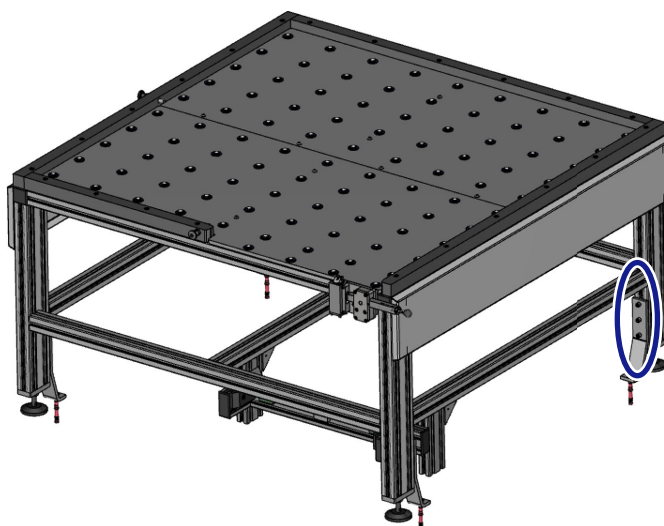
Fig. 4-54 Serraggio delle viti dell'angolare di fondazione (figura esemplificativa)
