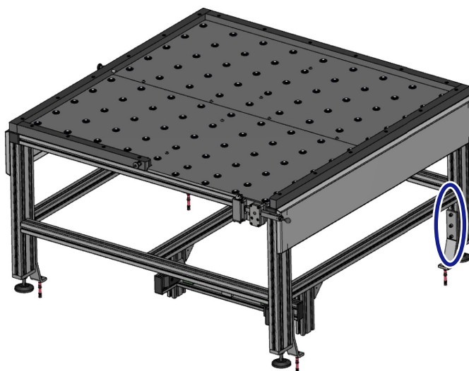
Fig. 4-54 Apretar los tornillos de la escuadra de fundación (figura a título de ejemplo)
